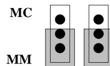
PHONO JUMPER SETTING FOR MOVING MAGNET (MM)
